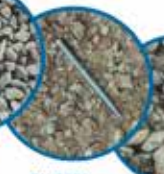
ZAHORRA DE HORMIGÓN
